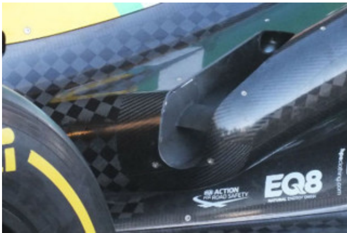
Áramlásjavító lap a CT03-as Coanda-kipufogó számára kialakított légcatornában (Fotó: Racecar Engineering)
