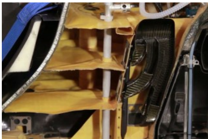
A Formula-1-es autó üzemanyag-ellátó rendszerének szerves része a pilóta mögött elhelyezett, kamrákra osztott speciális tartály (Fotó: Sauber F1 Team)
