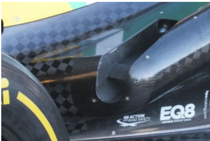
Áramlásjavító lap a CT03-as Coanda-kipufogó számára kialakított légsatornában (Fotó: Racecar Engineering)
