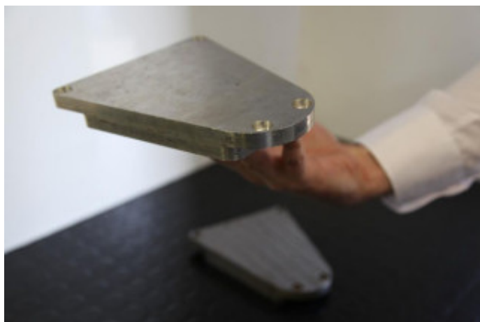
A Caterham CT03-as versenyautóban használt, 800g-os, alumíniumból készült ballaszt (Fotó: Caterham F1 Team / Twitter)
